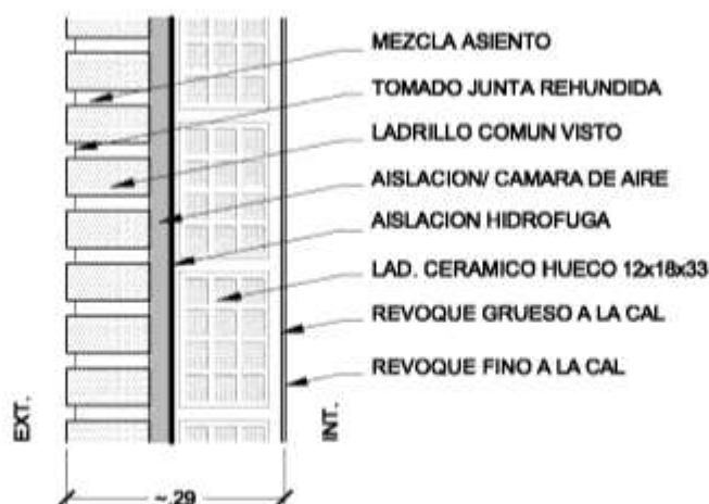
MURO DOBLE + AISLACION ó CAMARA DE AIRE. LADRILLO COMUN VISTO/ HUECO DE 12 - escala 1:10
