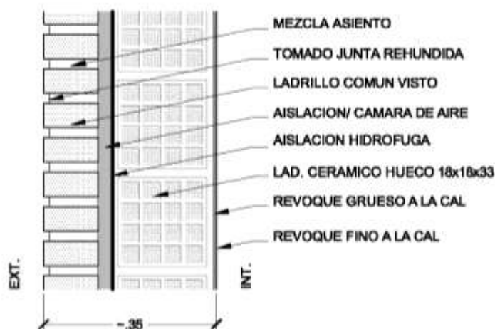
MURO DOBLE + AISLACION ó CAMARA DE AIRE. LADRILLO COMUN/ HUECO DE 18 - escala 1:10
