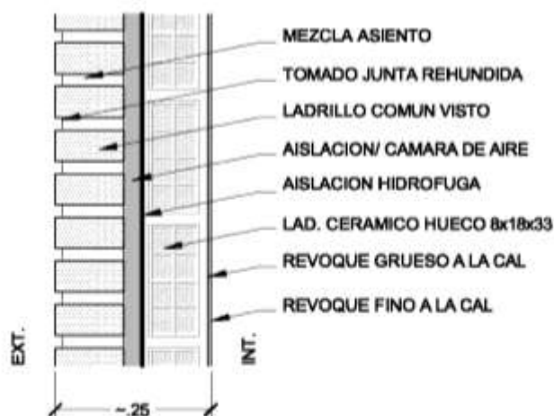
MURO DOBLE + AISLACION ó CAMARA DE AIRE. LADRILLO COMUN VISTO/ HUECO DE 8 - escala 1:10
