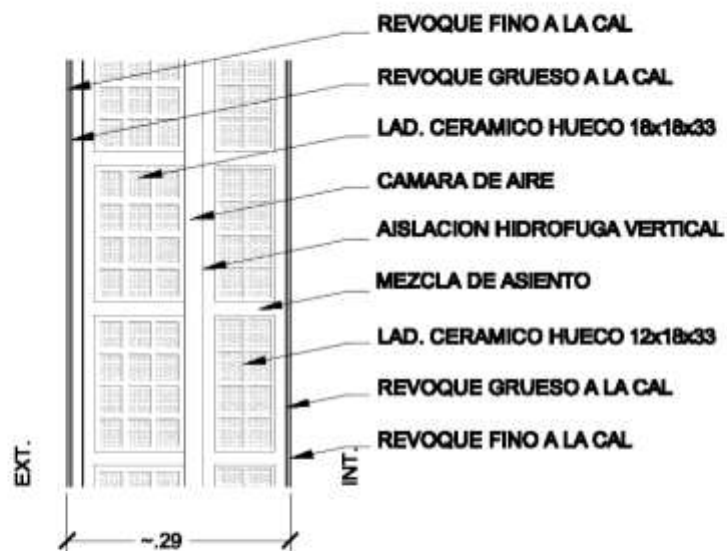
MURO DE LAD. CERAMICO HUECO DE 12 + CAMARA DE AIRE + LAD. CERAMICO HUECO DE 8 - escala 1:10
