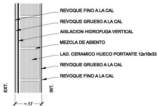
MURO DE LADRILLO CERAMICO PORTANTE DE 12x19x33 - escala 1:10
