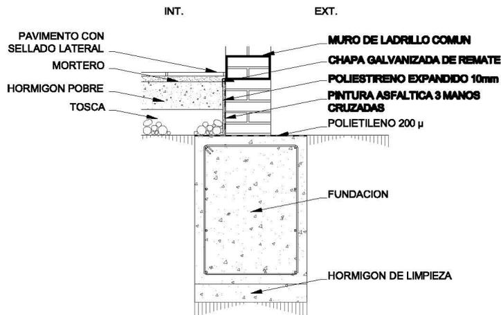
APOYO DE MURO SOBRE CIMENTACION - escala 1:20
